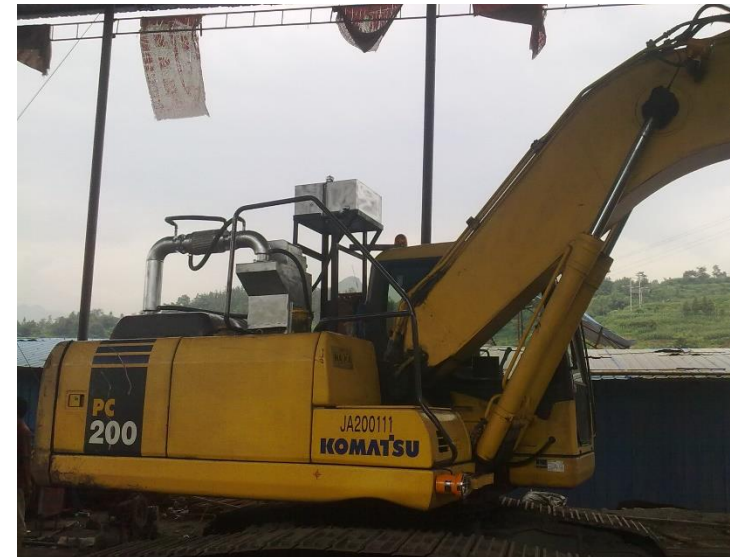
1、NC柴油机 2、散热器 3、滤清器 4、进气风门 5、进气箱 6、进气波纹管 7、补水箱 8、废气处理箱 9、储气管 10、排气管 11、排气波纹管 12、排气管 B1、水位传感器 B2、冷却水温传感器 B3、表面温度传感器 B4、排气温度传感器 B5、机油压力传感器 B6、瓦斯报警仪
